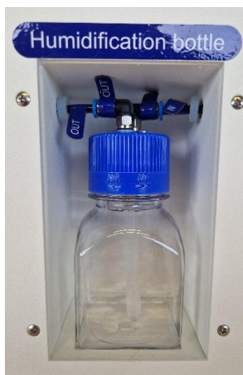
Figura 22.1 Conexión del tubo a la botella de humidificación y a la incubadora multicámara FIV Mini MIRI® Humidity
