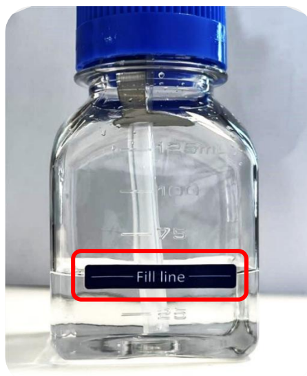
Figura 22.2 Línea de llenado en la botella de humidificación
